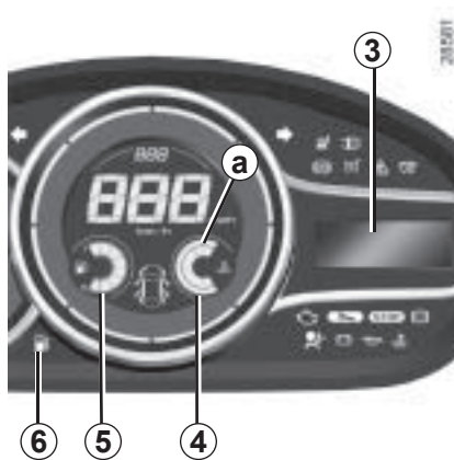
Сигнальная лампа минимального уровня масла в двигателе.
