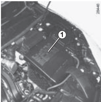
Аккумуляторная батарея 1 не требует специального технического обслуживания.
