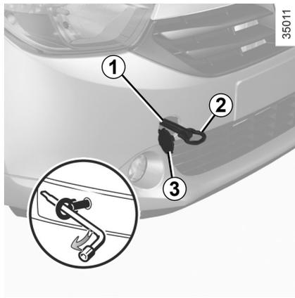
Используйте только места установки буксировочных проушин спереди 1 и сзади 4.
