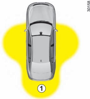
Если боковая дверь или крышка багажного отделения открыта или неплотно закрыта, или если карта находится в салоне автомобиля (или в считывающем устройстве), автомобиль не запирается. В этом случае, **нет звукового сигнала и мигания указателей поворотов.**
