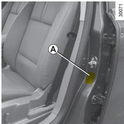
Давление накачки шин указано на этикетке **A**, наклеенной на кузов автомобиля. Для того, чтобы прочесть данные, откройте дверь.
