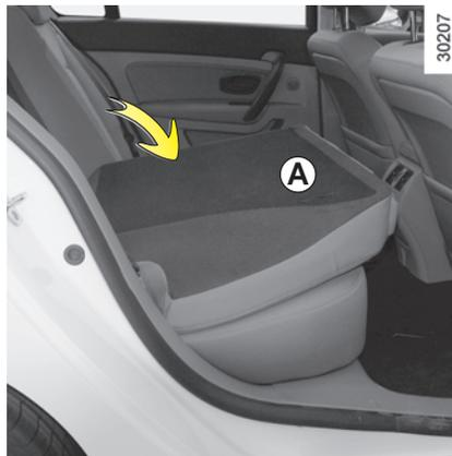
Для установки спинки сиденья в вертикальное положение приподнимите ее, затем проверьте надежность ее фиксации.
