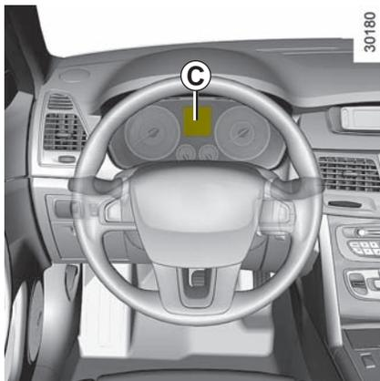
Следующие сигнальные лампы загораются на дисплее бортового компьютера в точке C:
