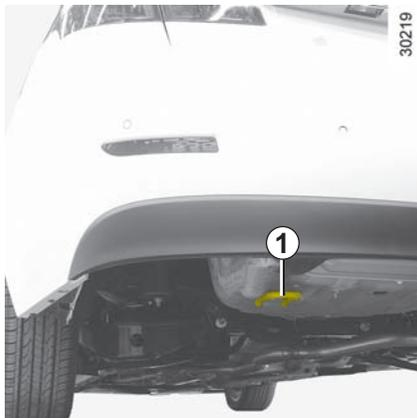
Используйте только заднее гнездо крепления **1** и переднее гнездо крепления **4** буксировочных проушин (ни в коем случае не используйте для буксировки валы привода колес). Эти гнезда крепления буксировочных проушин могут использоваться только для буксировки. Ни в коем случае они не могут, ни прямо, ни косвенно, использоваться для подъема автомобиля.
