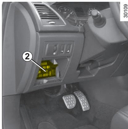
Для закрывания блока предохранителей, вставьте на место вещевого ящик **A**, начиная снизу.
