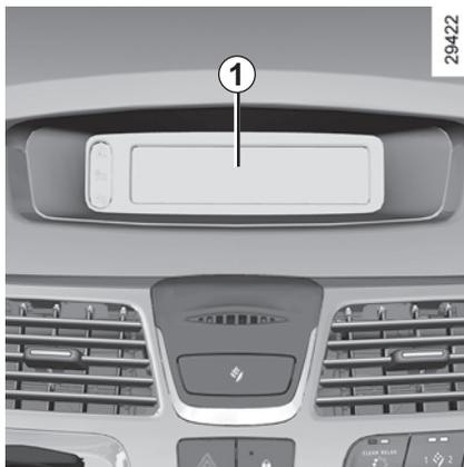
При включенном зажигании отображается время и, в зависимости от комплектации автомобиля, температура наружного воздуха.
