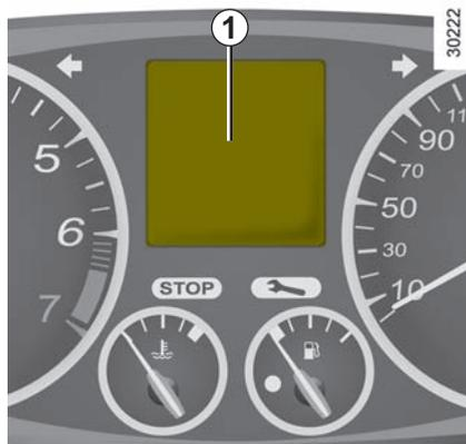
Эта функция встроена в бортовой компьютер **1** и позволяет включить/выключить, а также настроить некоторые функции автомобиля.
