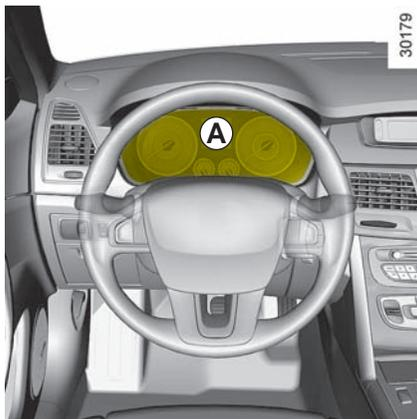
Щиток приборов **A** освещается при включении зажигания.
