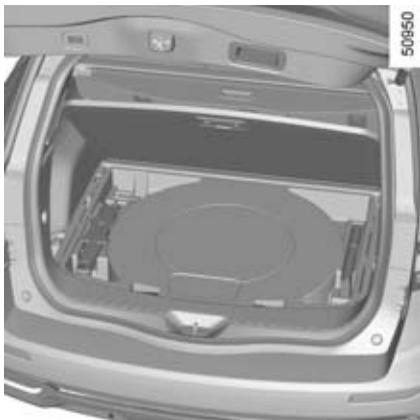
Наличие инструментов зависит от комплектации автомобиля. Инструменты находятся в отсеке под ковриком багажного отделения. Поднимите крышку и снимите их.
