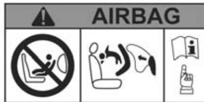
Маркировка на приборной панели и этикетки **A** с обеих сторон противосолнечного козырька **3** со стороны пассажира (образец этикетки вверху), напоминают об этих указаниях.
