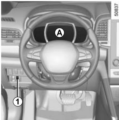
Щиток приборов **A**: загорается при открывании двери водителя. При включенном зажигании поверните колесо регулятора **1**, чтобы настроить яркость щитка приборов.
