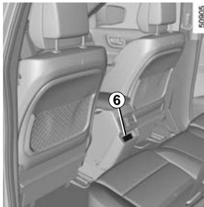
Разъемы USB также можно использовать для подзарядки устройств, отвечающих требованиям производителя, при максимальной мощности 10,5 Вт (при напряжении 5 В) на каждый разъем.
