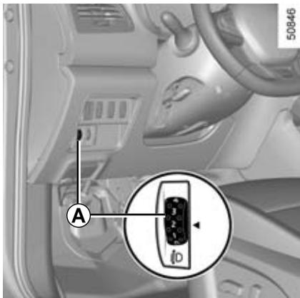
В автомобилях, оснащенных такой системой, переключатель **A** позволяет регулировать направление световых лучей по высоте в зависимости от нагрузки автомобиля.
