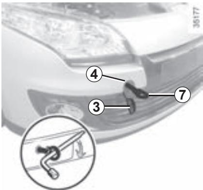
Используйте только места установки буксировочных проушин спереди 4 и сзади 5.
