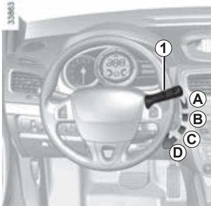
**Автомобиль, оснащенный стеклоочистителем ветрового стекла с прерывистым режимом работы**
