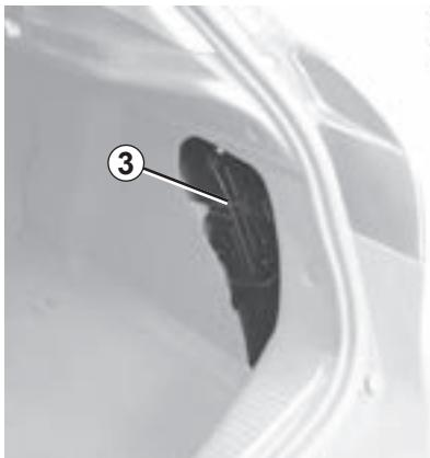
Чтобы вынуть инструменты, снимите ремень 3. После использования установите ремень на место для удержания инструментов.
