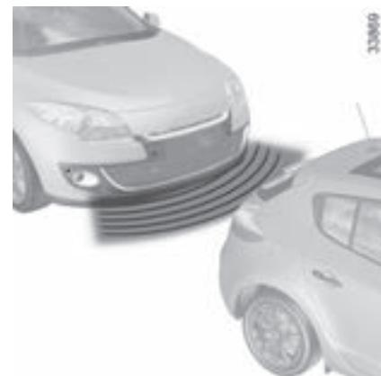
**Примечание.** В зависимости от комплектации автомобиля, на дисплее **A** может отображаться зона рядом с автомобилем и раздаваться звуковой сигнал.
