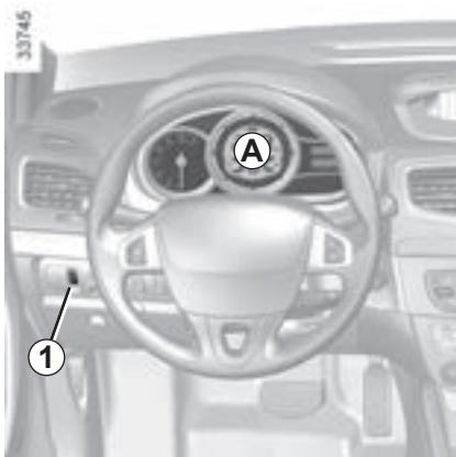
Щиток приборов включается при включении зажигания. Вращайте колесико **1** для регулировки яркости подсветки щитка приборов. В некоторых случаях включение сигнальных ламп сопровождается сообщением.
