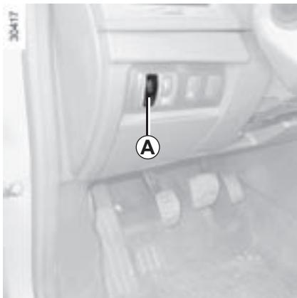
Для автомобилей, имеющих такую функцию, регулятор **A** позволяет регулировать направление световых лучей по высоте в зависимости от загрузки автомобиля.
