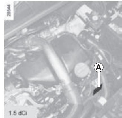
При заказе запасных частей необходимо ссыльаться на информацию, которая содержится на табличке на двигателе или на наклейке А
