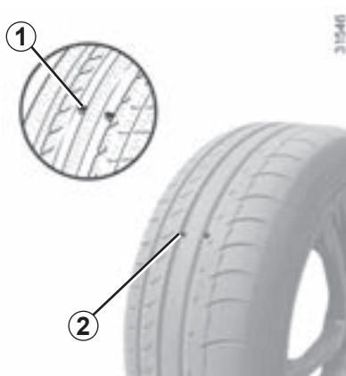
При износе рельефа протектора до уровня, когда выступы индикатора **2 становятся видны**, необходимо заменить шины, т. к. глубина рисунка протектора уменьшилась до 1,6 мм, что приводит к плохому сцеплению на мокрой дороге.
