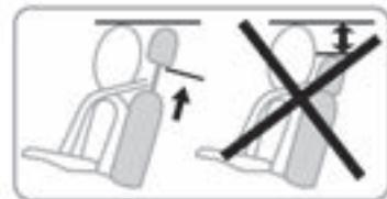
Три верхних положения доступны без нажатия на кнопку 2. Однако, при опускании подголовника желательно нажимать на кнопку.
