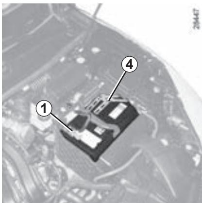
Присоедините плюсовый провод **A** к **держателю 1**, закрепленному на **клемме 4 (+)**, а затем подсоедините его к **клемме 2 (+)** вспомогательной аккумуляторной батареи.
