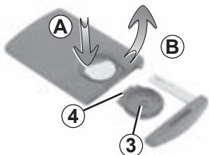
Сборку выполняйте в обратном порядке, затем, находясь в непосредственной близости от автомобиля, нажмите четыре раза на одну из кнопок карты: при следующем запуске двигателя сообщение исчезнет.
