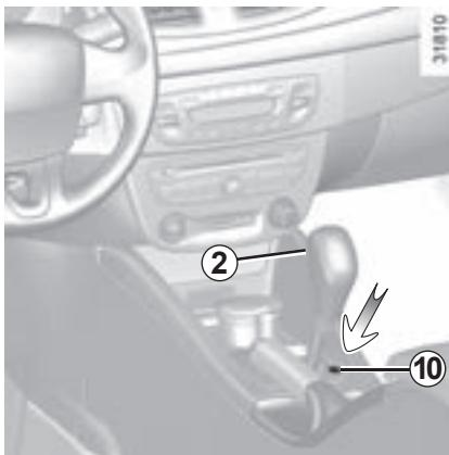
**Если при переключении** рычаг заблокирован в положении **P**, при нажатии на педаль тормоза и на кнопку разблокировки **2** имеется возможность разблокировать рычаг вручную. Для этого нажмите на кнопку, вставив какой-либо предмет в отверстие **10** и одновременно нажмите на кнопку разблокировки **2**, находящуюся на ручке рычага селектора.
