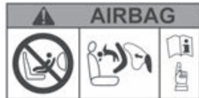
Маркировка на щитке приборов и этикетки А с каждой стороны противосолнечного козырька переднего пассажира 3 (выше приведен пример этикеток) напоминают вам об этих предупреждениях.
