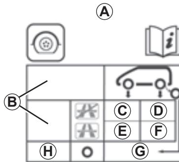
**C:** давление воздуха в шинах передних колес при езде вне автострады.
