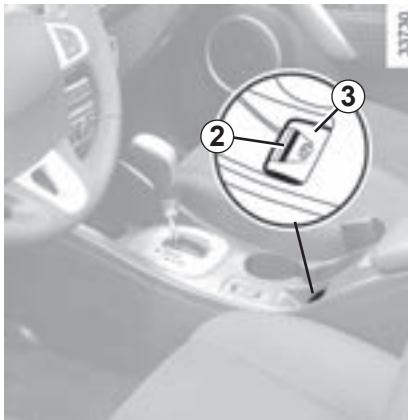
Включение автоматического стояночного тормоза подтверждается сообщением «Стояночный тормоз включен» (Стояночный тормоз включен) и сигнальной лампой
