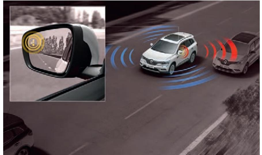
**Система контроля слепых зон** следит за транспортными средствами, движущимися позади автомобиля, чтобы вовремя предупредить Вас о неожиданных помехах при перестроении, включив световой индикатор на зеркалах заднего вида.
