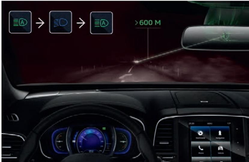
**Система автоматического переключения дальнего света фар** заботится не только о Вас, но и об окружающих. Если Вы въезжаете в населенный пункт, движетесь за попутным автомобилем либо навстречу автомобилю, система автоматически переключит дальний свет фар на ближний, обеспечивая максимальную видимость всем участникам движения в темное время суток.
