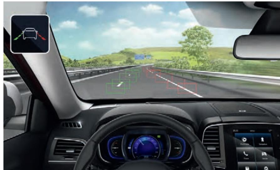
**Система контроля рядности движения** следит за движением в выбранной полосе. Система предупреждает водителя о непреднамеренном пересечении прерывистой или непрерывной линии разметки, если при этом указатели поворота не были включены.
