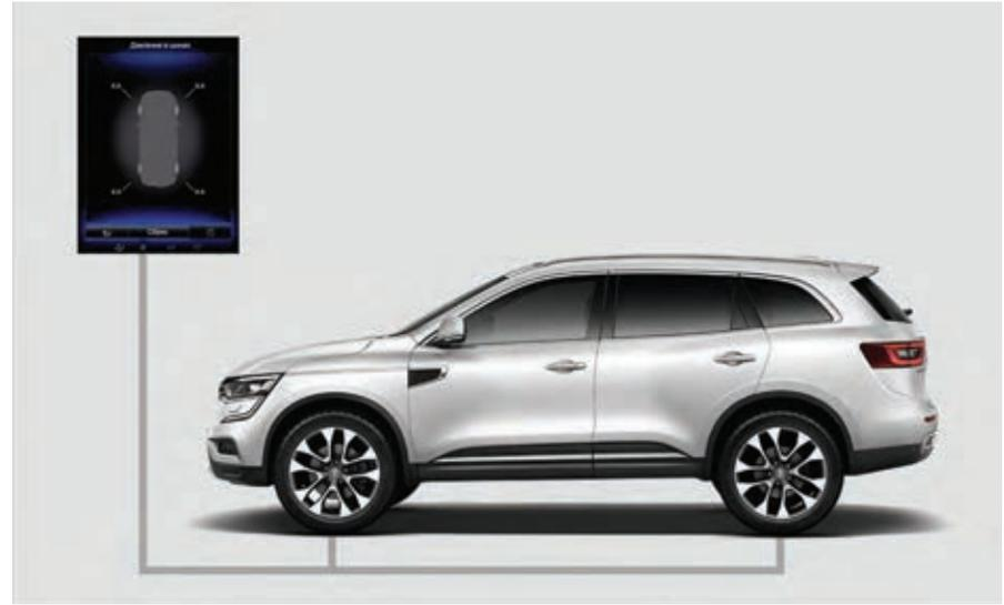
**Система контроля давления в шинах** предназначена для предупреждения об опасном изменении давления в шинах. Данные системы выводятся на экран бортового компьютера в режиме реального времени.
