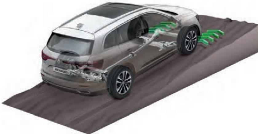
Двигаясь на сухом покрытии, выберите экономичный режим 4x2, передающий крутящий момент на передние колеса. Это позволит снизить потребление топлива.
