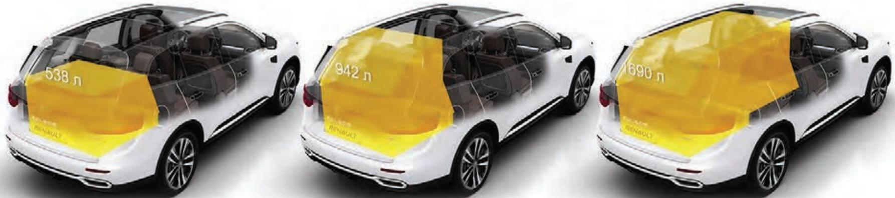
Модулируемость салона позволяет расширять багажное пространство в соответствии с вашими потребностями. Задние сиденья могут быть сложены автоматически благодаря системе Easy Break — одним нажатием кнопки объем для погрузки увеличивается более чем в два раза.
