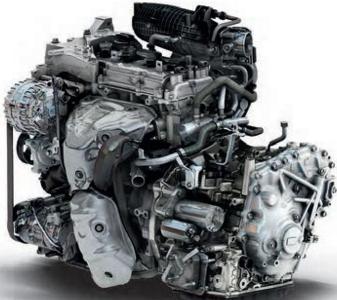
Бензиновый двигатель 2.0 л (145 л.с.) оснащен системой непосредственного впрыска топлива и имеет блок цилиндров из литого алюминия, благодаря чему у него достаточно компактные размеры и небольшая масса и он выдает 144 л.с. при 6000 об/мин, а пиковый крутящий момент составляет 200 Н·м при 4400 об/мин. Так как 80% крутящего момента доступно уже с 2400 об/мин, этот двигатель обеспечивает хорошую динамику и низкий расход топлива.
