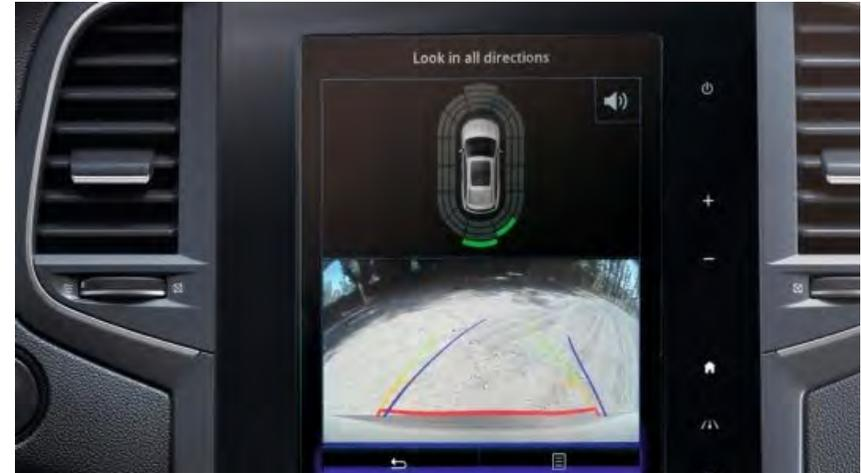
**Камера заднего вида** Renault KOLEOS скомбинирована с датчиками парковки, расположенными по всему периметру автомобиля. Изображение с камеры и круговая схема парковки выводятся на экран мультимедийной системы R-LINK 2.
