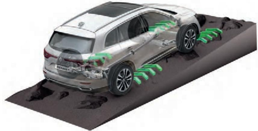
Передвигаясь по песку, грязи или каменистой местности, включите режим Lock: постоянный полный привод и фиксированное распределение крутящего момента обеспечат автомобилю максимальную проходимость и точную управляемость даже в таких сложных ситуациях.
