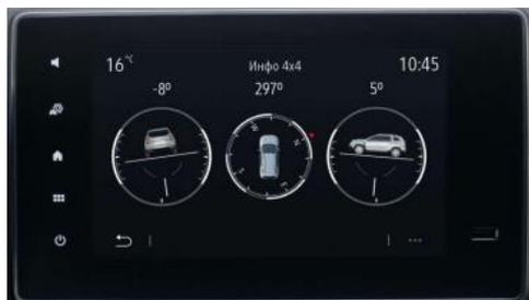
Монитор 4x4 на экране мультимедийной системы отображает угол крена, угол тангажа и компас
