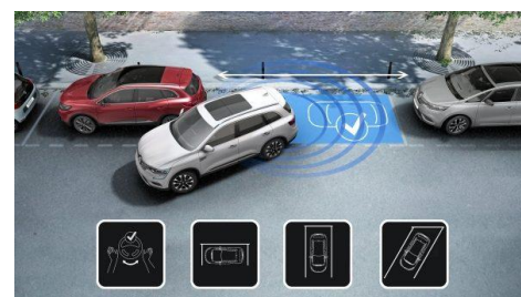
Система автоматической парковки найдет свободное место и осуществит парковку сама, без участия водителя
