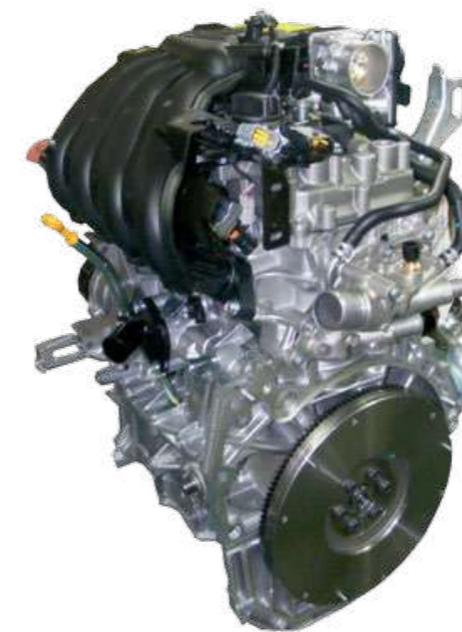
**Бензиновый двигатель 1.6 л (114 л.с.)** – отличается уверенной тягой в широком диапазоне оборотов благодаря двойному фазорегулятору, а также низким расходом топлива и низкой стоимостью эксплуатации. Например, цепной привод газораспределительного механизма не требует обслуживания на протяжении всего срока службы автомобиля.
